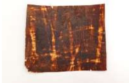
Рис.2. Композит с ФФС по технологии прокапывания (сторона 1)
