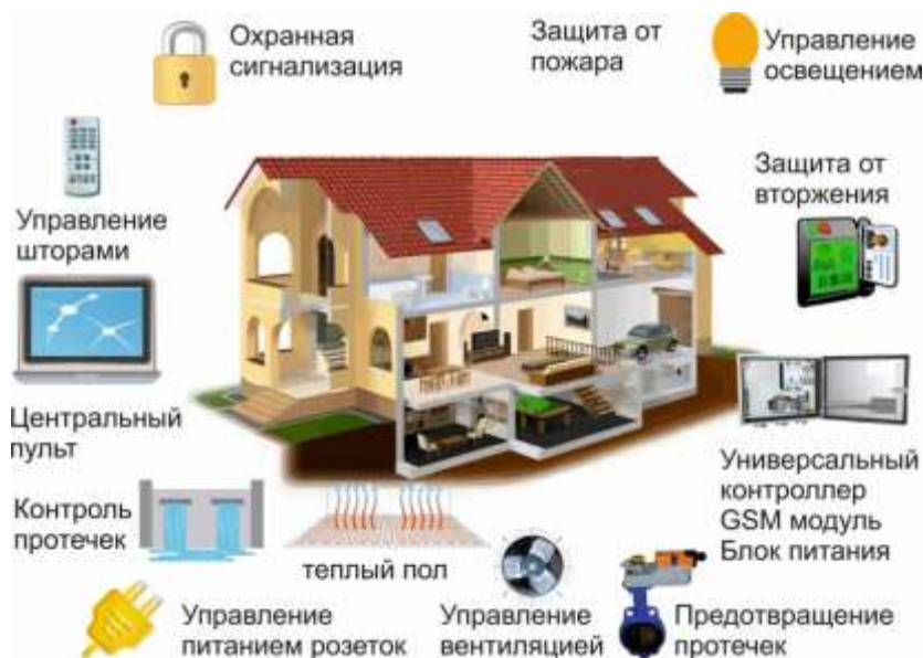
Рис.2. Устройство системы умного дома
