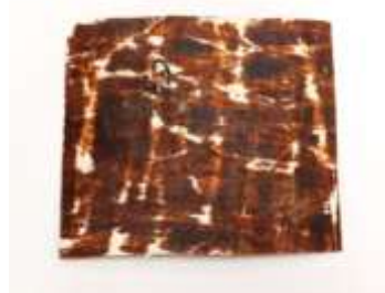
Рис.3. Композит с ФФС по технологии прокапывания (сторона 2)
