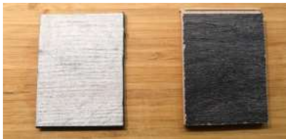
(Рис. 5.) Общий вид образцов плитки ПВХ и ламината до испытания.
