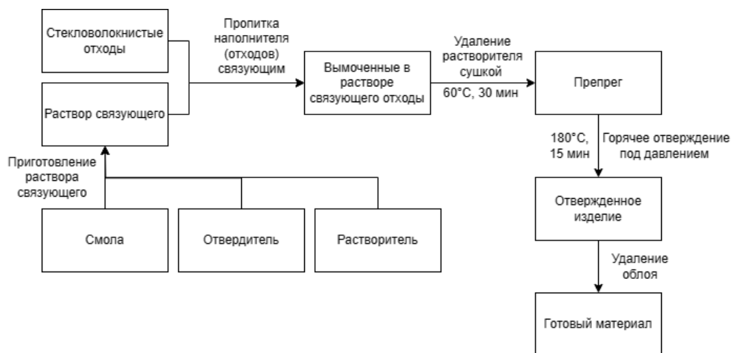
Рис. 4. Блок-схема технологии получения пресс-материалов с использованием ФФС
