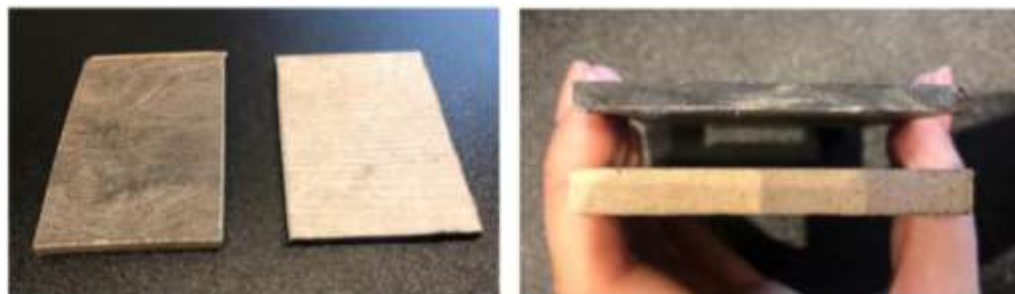
(Рис. 3.) Образцы ламината и плитки ПВХ до испытаний: а – общий вид, б – толщина.
