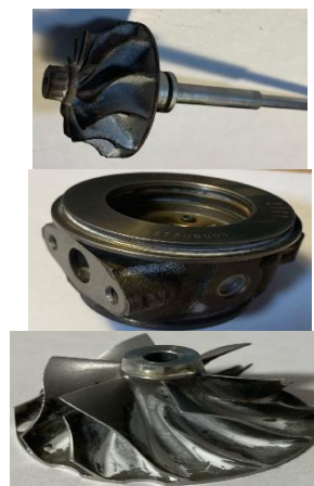
Рисунок 4 – Основные детали для 3D – сканирования (а – деталь “вал турбокомпрессора”, б – “корпус”, в – “колесо компрессора”)
