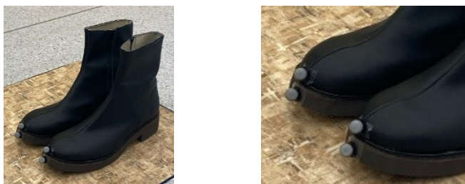
Рис. 6. Положение маркеров для измерения приподнятости носочной части
