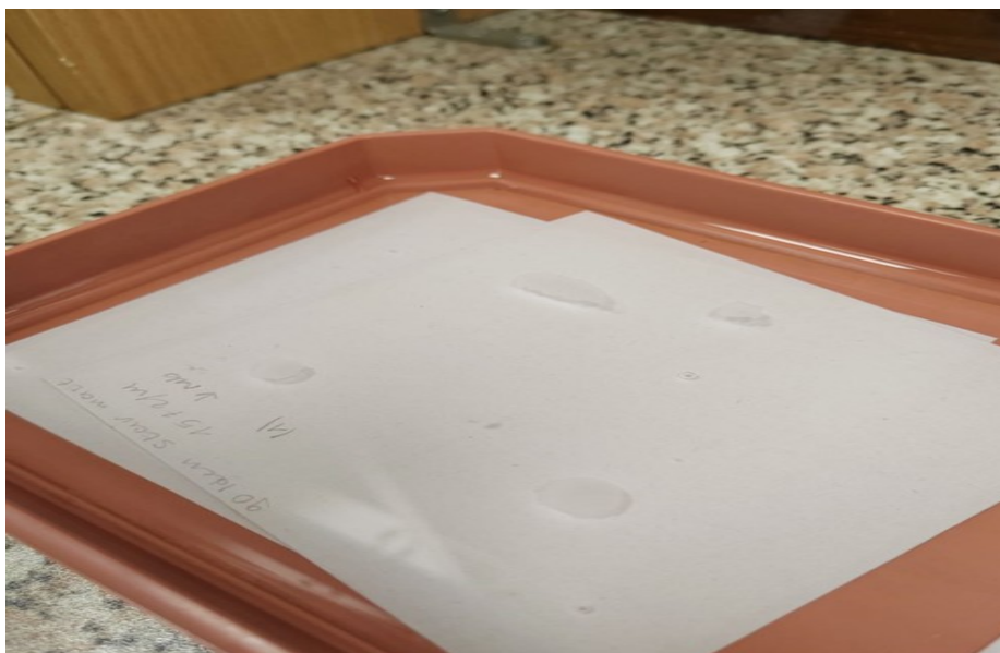
Рис. 1. Кювета с образцами бумаги Snow Eagle матовая 157 г/м 2 Кобб-тест и испытания на скручивание при одностороннем смачивании, хотя и не
