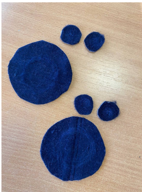
Рис. 7. Образцы после испытания на стойкость к истиранию
