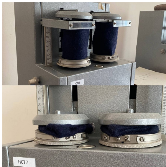
Рис. 6. – Образцы при сжатии прибором НСП
