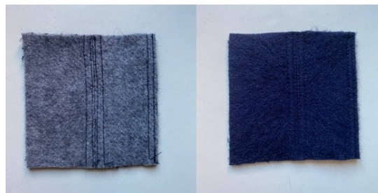
Рис. 3. Образец и схема шва вразутюжку с применением машинных строчек
