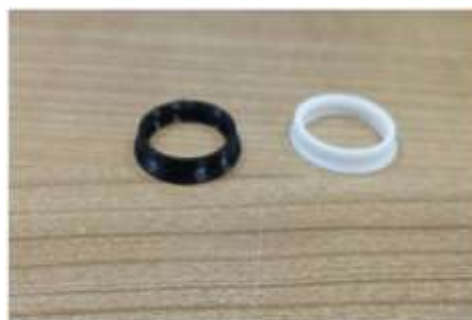
Рис. 3. Направляющее уплотнение пуансона таблет-пресс (оригинальная деталь – слева, 3Д копия – справа)
