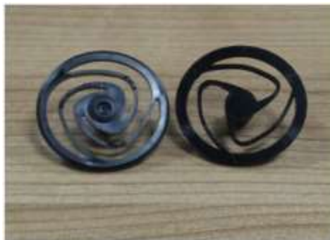
Рис. 1. Держатель платформы весов (оригинальная деталь – слева, 3Д копия – справа)
