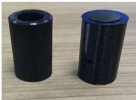
Рис. 2. Фиксатор крепления форсунки для хроматографа
