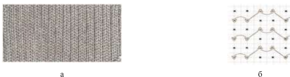
Рис.10 Ластичное переплетение 2+2: а – фото переплетения, б – графическая запись
