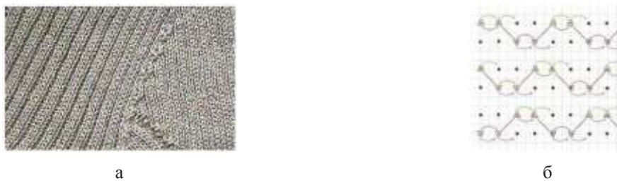
Рис.11. Кулирная гладь: а – лицевая сторона, б – графическая запись
