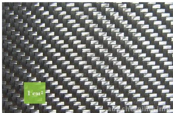
Рисунок 1. Структура углепластика
