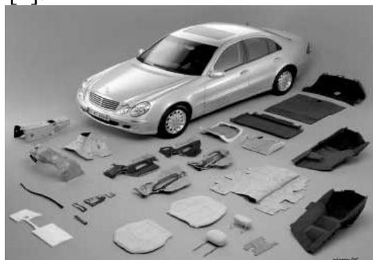
Рисунок 2. Применение композитов на основе натуральных волокон
